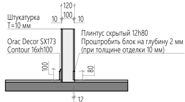
Разрез 03 Устройство стен ГКЛ под скрытый плинтус Разрез 02 Устройство стен ПГП под скрытый плинтус М 1:20
