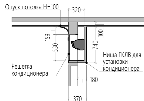
Разрез 01- 01 Размещение кондиционера в антресоли М 1:40
